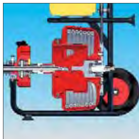
Защита спирали благодаря принудительному направлению в барабане
