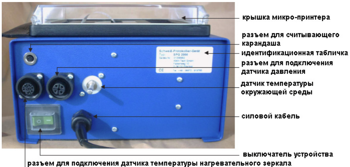
Рисунок 3.2: Вид сзади, разъемы (показан SPG 2000, у SPG 2000 Basic отсутствует микро-принтер)
